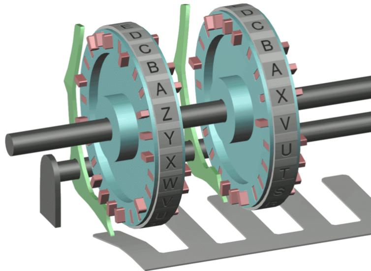
wo die Bolzen allerdings nicht ein Zahnrad weiterbewegen, sondern einen Hebel auslenken. [Die M-209 ist auch ein Schlüssel-Erzeuger und keine eigentliche Rotor-Maschine.]
